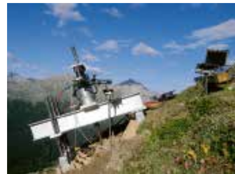
Prüfeinrichtung mit hydraulischem 40-t-Zylinder und Deformationsmessung.
