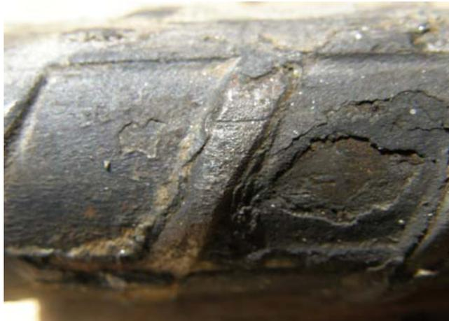
**Abb. 6.10:** Schwarze Schicht bei Position 3.7 m auf Anker der Ausgrabung E
