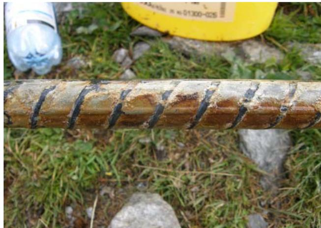
**Abb. 6.11:** Korrodierte Mörtelrückstände auf Anker bei Position 1.6 m
