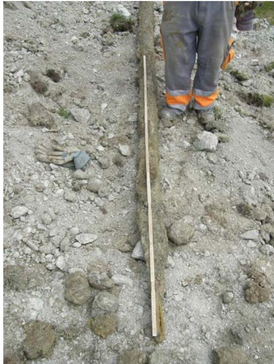
**Abb. 6.7:** Anker C nach dem Herausheben
