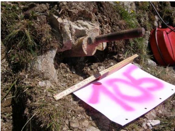
**Abb.7.2.4:** Baugrundabsenkung bei Anker 105 der Werkreihe 33
