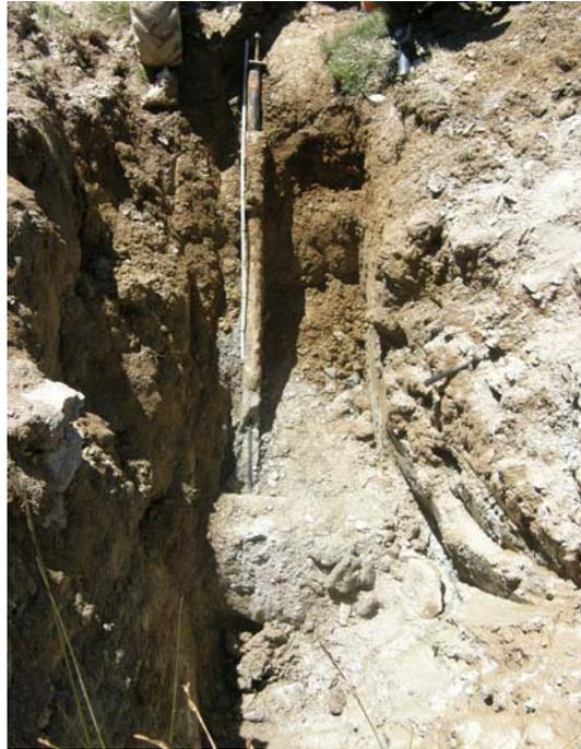
**Abb. 6.2:** Ansicht freigelegter Anker A
