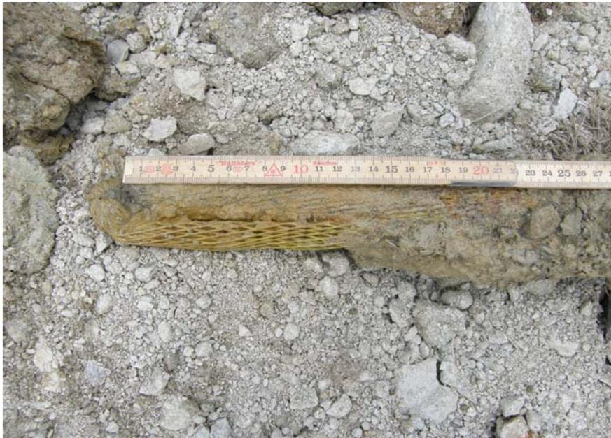
**Abb. 6.6:** Fehlender Mörtel am Ankerfuss
