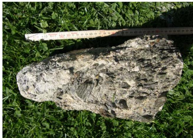
**Abb. 6.16:** Mörtelprobe Anker A, Handstück 2, nach dem Waschen
