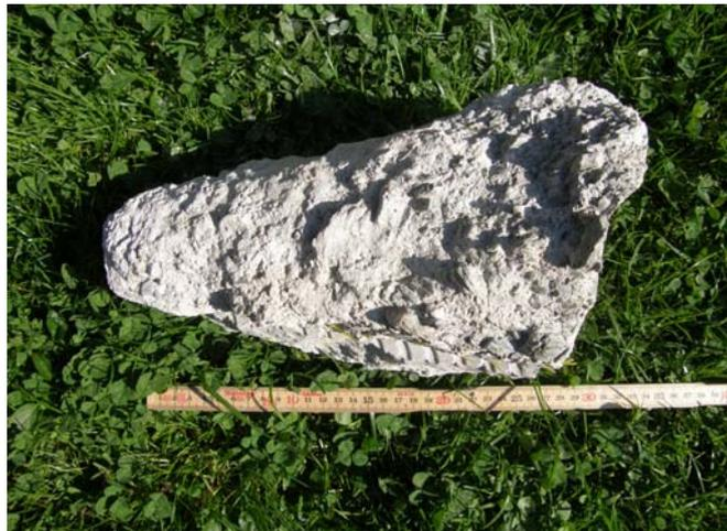
**Abb. 6.15:** Mörtelprobe Anker A, Handstück 2, vor dem Waschen
