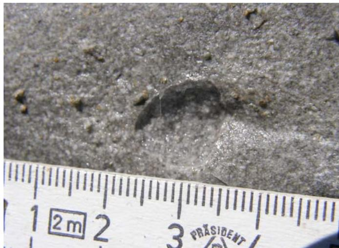
**Abb. 6.17:** Aufgebrochene, mit Wasser gefüllte Pore auf Handstück 3
