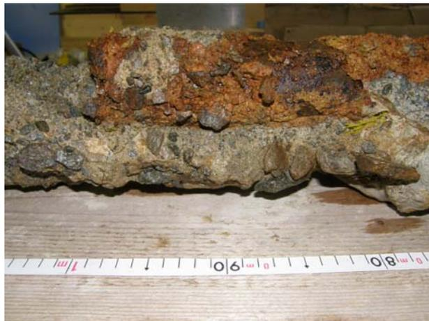
**Abb. 6.12:** Schutzrohr exzentrisch im Übergang zum Ankermörtel
