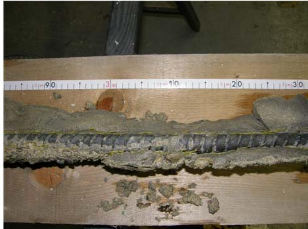
**Abb. 6.13:** Ankerstrumpf liegt am Anker an
