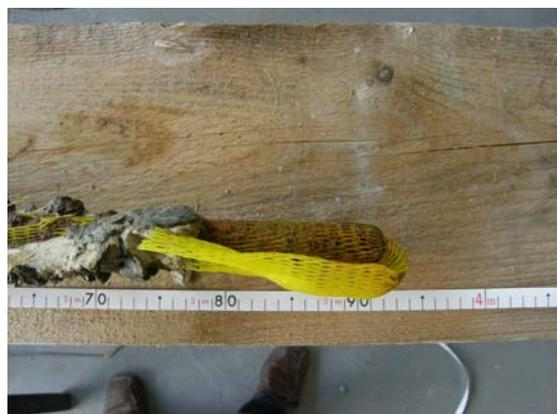
**Abb. 6.14:** Ankerkopf mit sichtbarem Ankeretz
