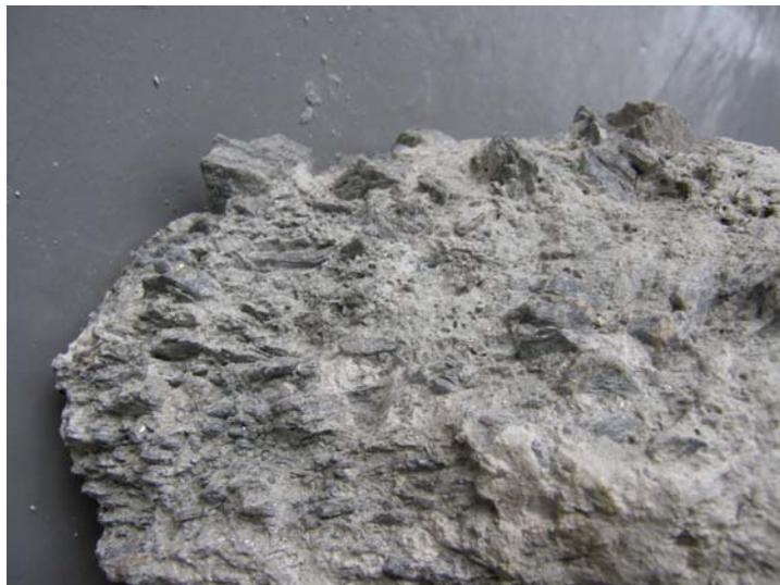
**Abb. 6.3:** Relativ hohe Rauigkeit auf der Unterseite bei Position 2.5 m
