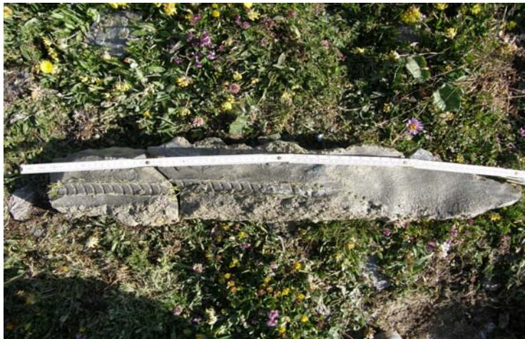
**Abb. 6.4:** Durch Baggerschaufel abgeschlagener Ankermörtel
