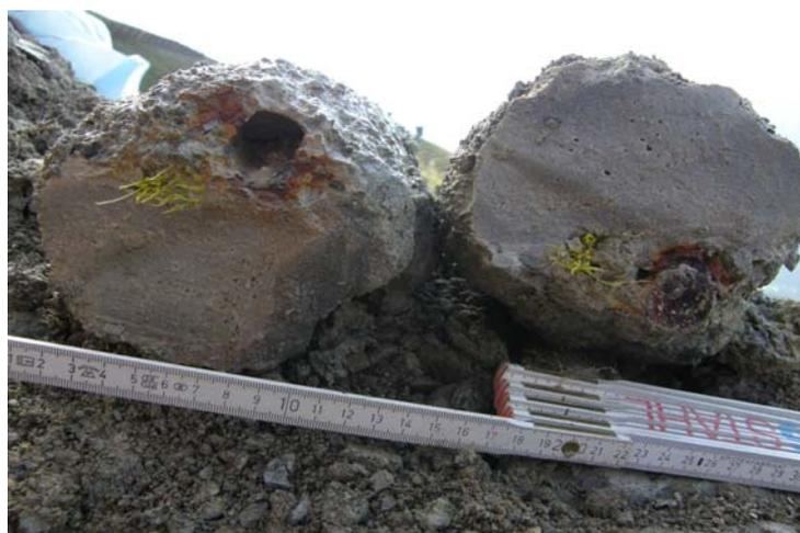
**Abb. 6.5:** unterster Teil des Mörtelkörpers, der abgebrochen ist
