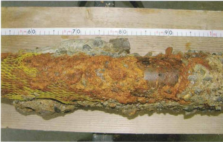
Abb. 3: Exzentrisches Schutzrohr mit starker Korrosion.
