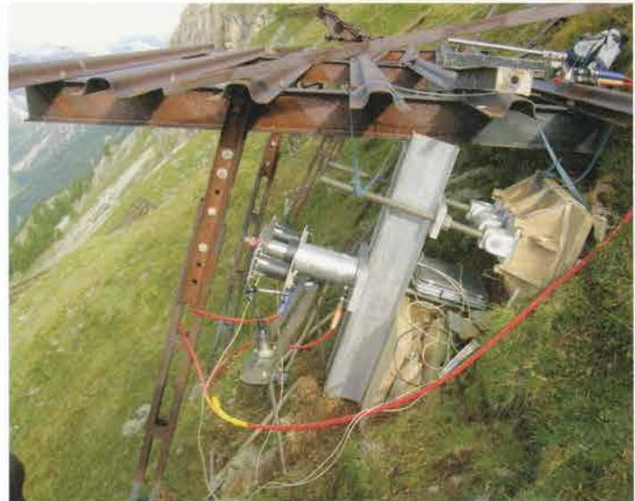
Abb 2: Zugprobe an einer bestehenden Schneebrücke, LV Munt da Lü.
